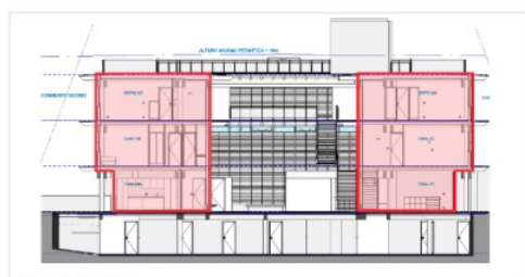
Perímetro de aislación en corte
