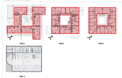
Perímetro de aislación en planta
